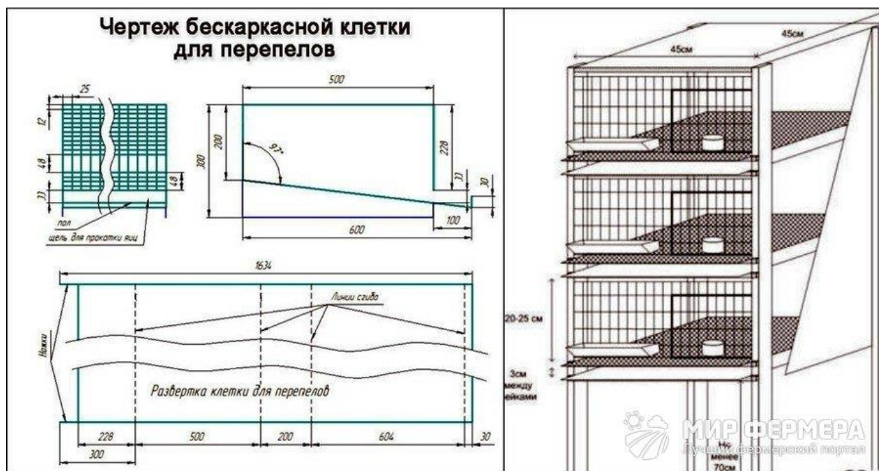
Рис. 7. Чертежи для изготовления клеток для молодняка и взрослых перепелов
